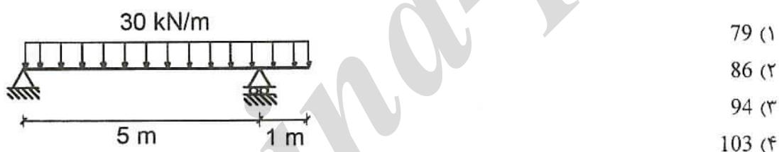
۶۰- لنگر خمشی در بالای هر ستون بر حسب  $\text{kN.m}$  چقدر است؟ (اتصال میانه تیر مفصلی است)
