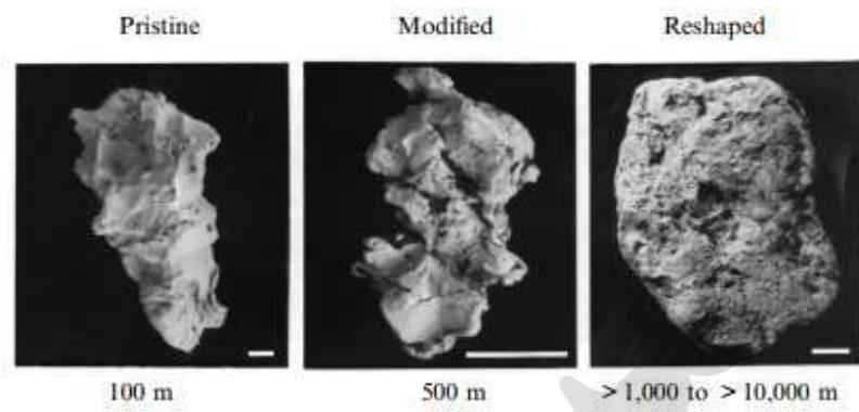
شکل 2: تصاویر الکترونی انتشار پسین ذرات طلا از رسوبات یخچالی تیل که نشان دهنده رابطه بین فرسایش دانه و فاصله انتقال یخچالی است. فرایند فرسایش می تواند به صورت فشاری باشد و موجب کاهش وزن و جرم دانه های طلا نمی شود.
